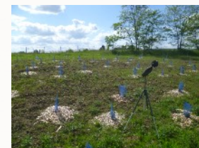
Suivi environnemental d'ICPE: mesure de bruits en carrière (arrêté du 22 septembre 1994)
